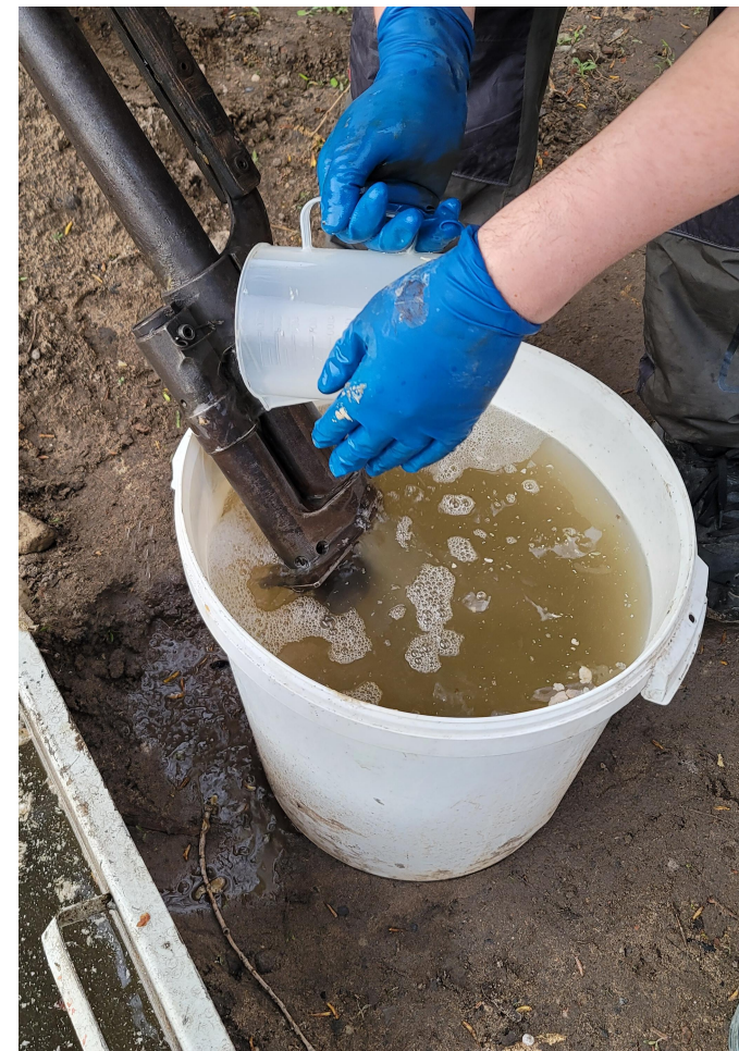
Расконсервация и очистка автомата ЗУ в полевых условиях
